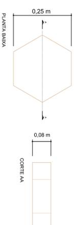
**DETALHE DO MEIO FIO DE CONCRETO**
