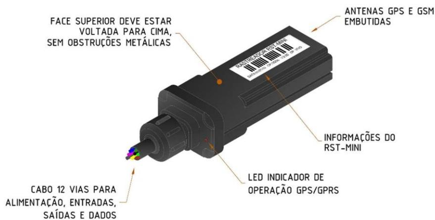
O Rastreador RST-MINI possui corpo plástico em ABS, possuindo um chicote para alimentação, aquisição de dados ou atuação de equipamentos externos. As antenas de GPS e GSM são internas, não havendo conectores externos para estas funções.
